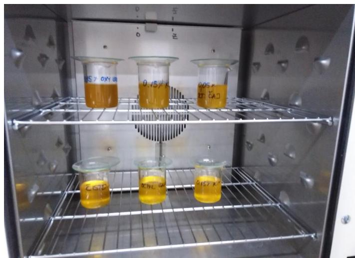
Slika 7. Termostat za određivanje oksidacijske stabilnosti lanenog ulja (Izvor:
