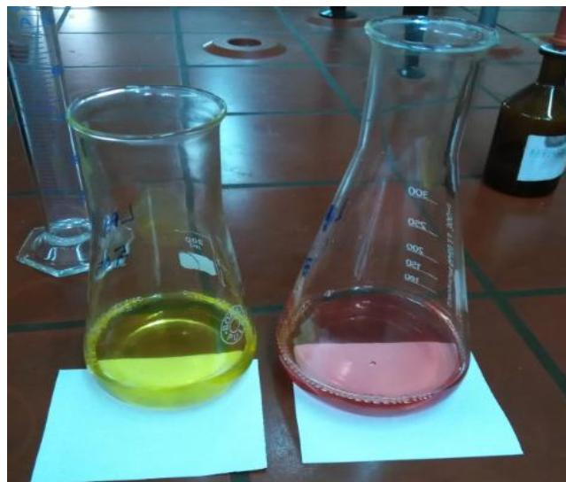
Slika 4. Određivanje SMK titracijom s NaOH (Izvor: autor)
