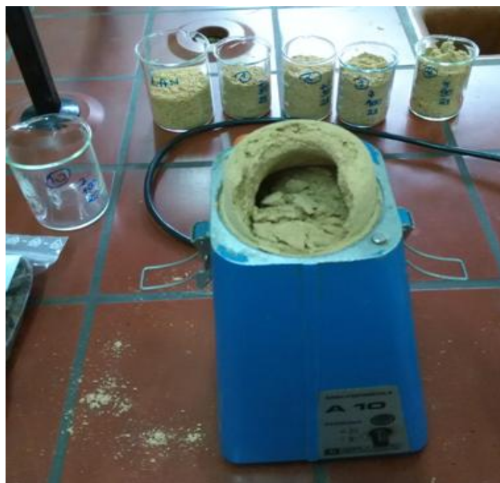
Slika 3. Mljevenje pogače s laboratorijskim mlinom (Izvor: autor)
