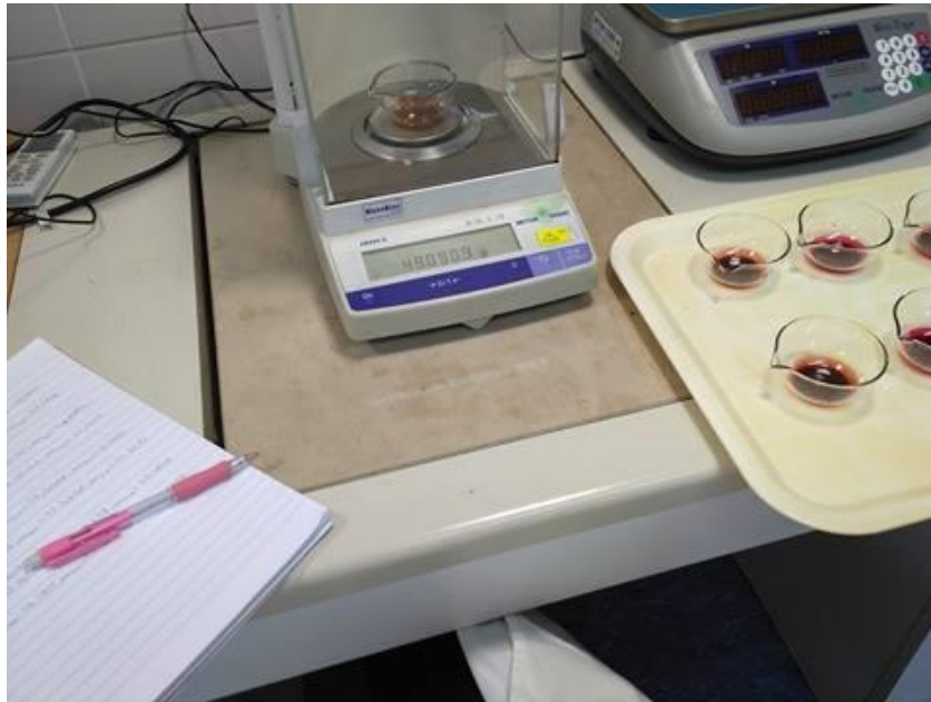
Slika 7. Vaganje uzoraka na analitičkoj vagi (Izvor: autor)
