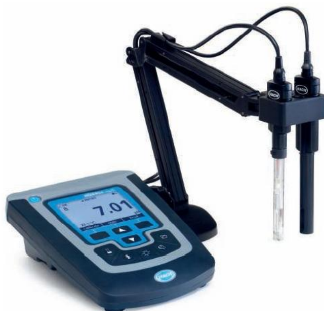
Slika 7. Uređaj za mjerenje fluorida (Hach.com, URL, 02.11.2017.)
