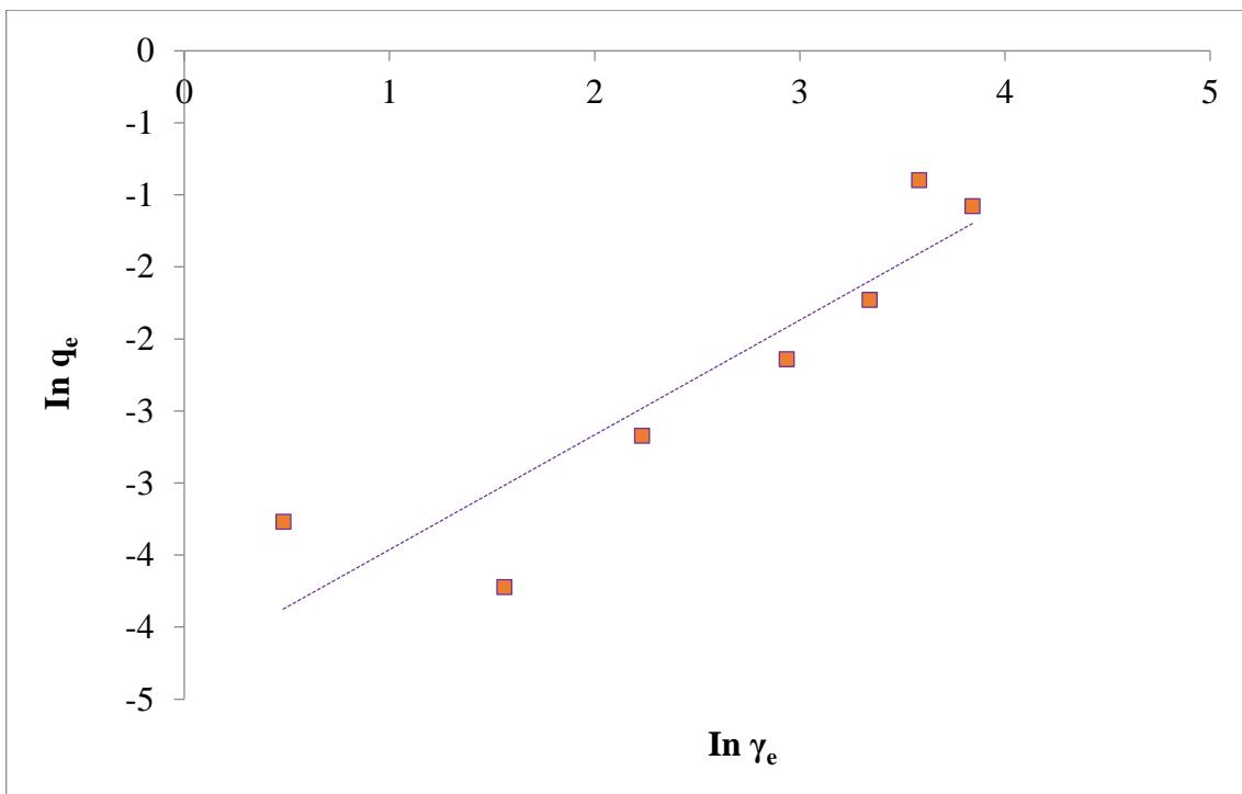
Slika 16. Freundlich-ova izoterma adsorpcije fluoridnih iona na adsorbens pri temperaturi  $35\text{ }^{\circ}\text{C}$
