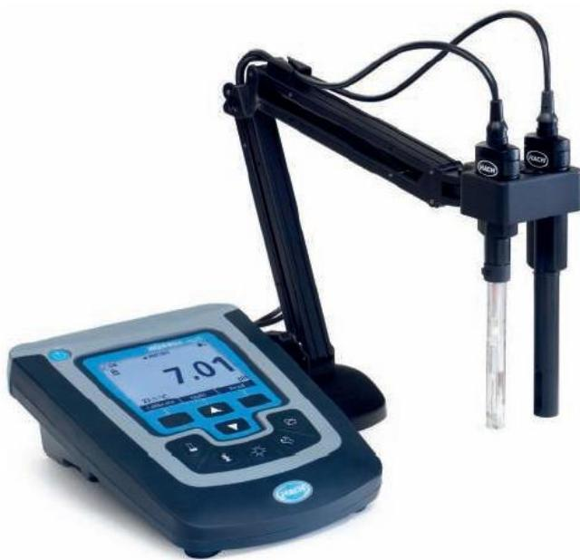
Slika 7. Uređaj za mjerjenje fluorida (Hach.com, URL, 02.11.2017.)
