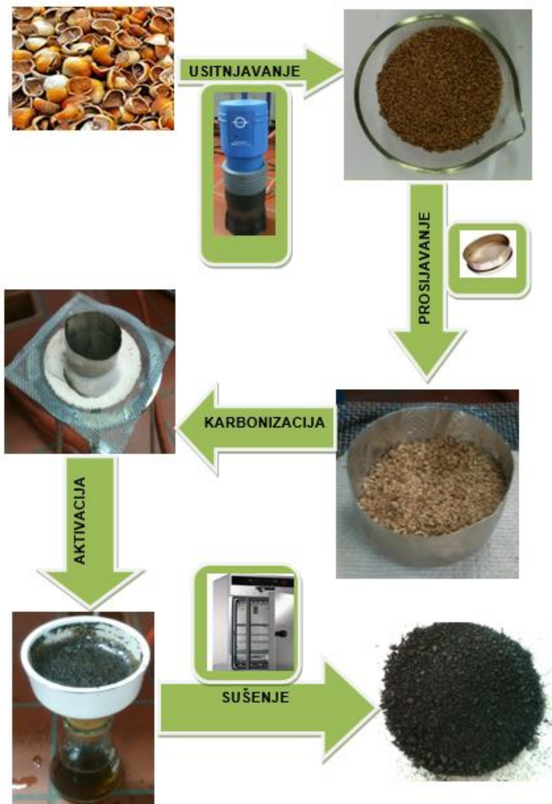
Slika 4. Proces proizvodnje aktivnog ugljena (Izvor: autor)
