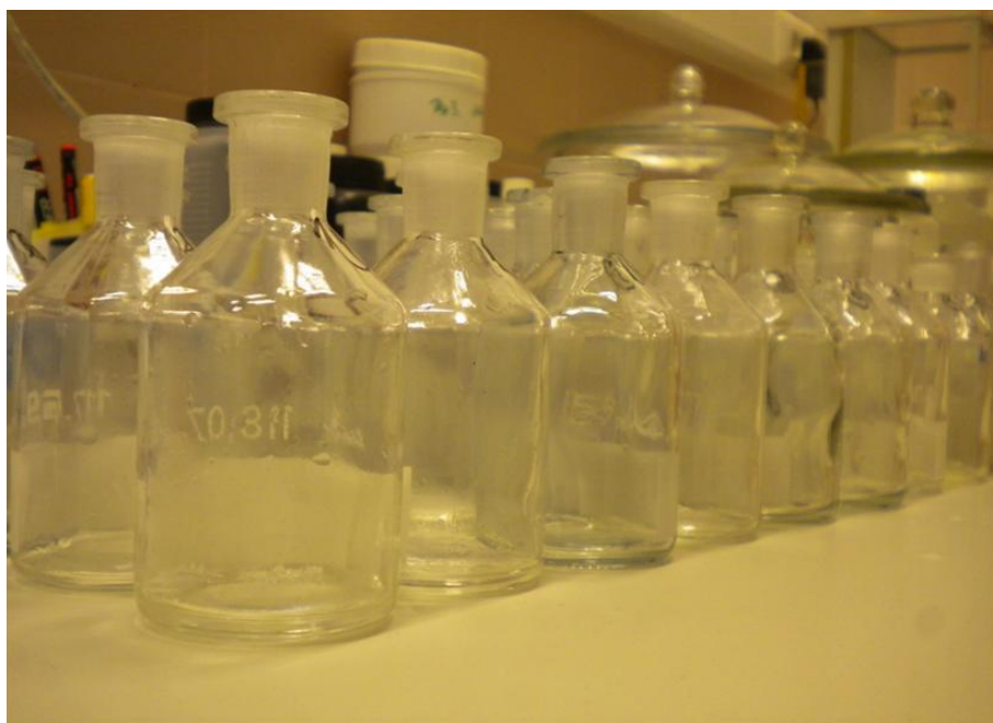
Slika 5. Winklerove bočice (Izvor: autor)
