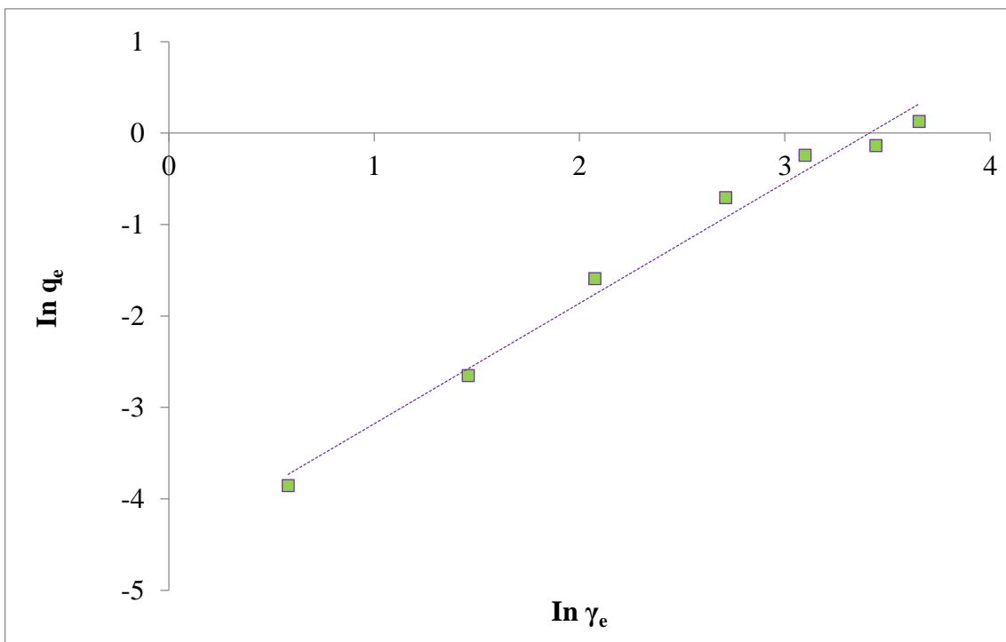
Slika 15. Freundlich-ova izoterma adsorpcije fluoridnih iona na adsorbens pri temperaturi  $25\text{ }^{\circ}\text{C}$
