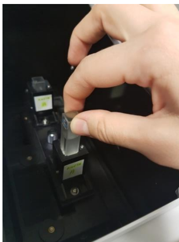
Slika 18. Označena mjesta za kivete u unutrašnjosti spektrofotometra (Izvor: autor)
