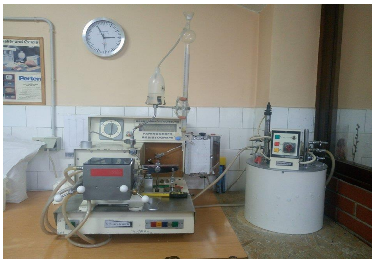
Slika 4. Uređaj farinograma u laboratoriju Papuka (Izvor: autor )
