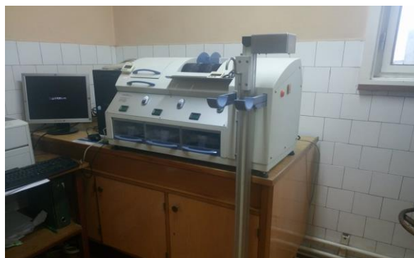
Slika 5. Uređaj ekstenzograma u laboratoriju Papuka (Izvor: autor )
