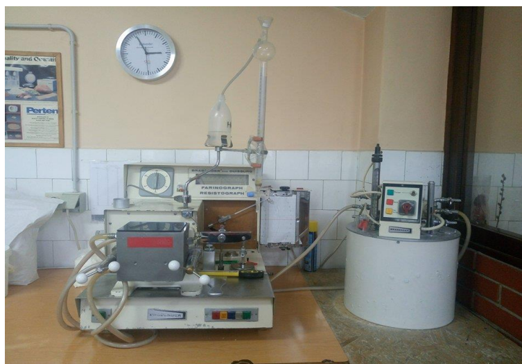
Slika 4. Uređaj farinograma u laboratoriju Papuka (Izvor: autor )
