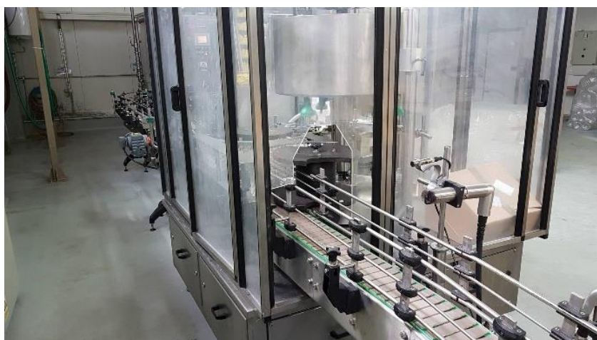
Slika 9. Uređaj za punjenje ulja (Izvor: „autor“, 09.03. 2017.)
