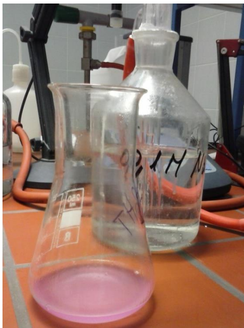
Slika 8. Određivanje kiselnog broja (Izvor: autor)
