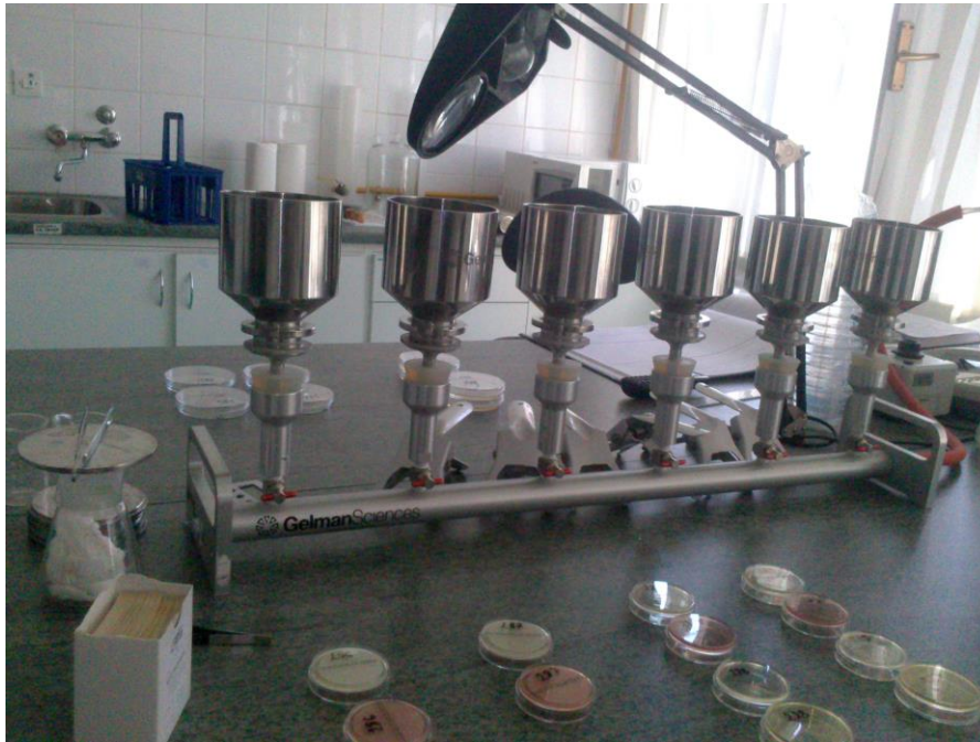
Slika 4. Uređaj za membransku filtraciju (Izvor: autor)
