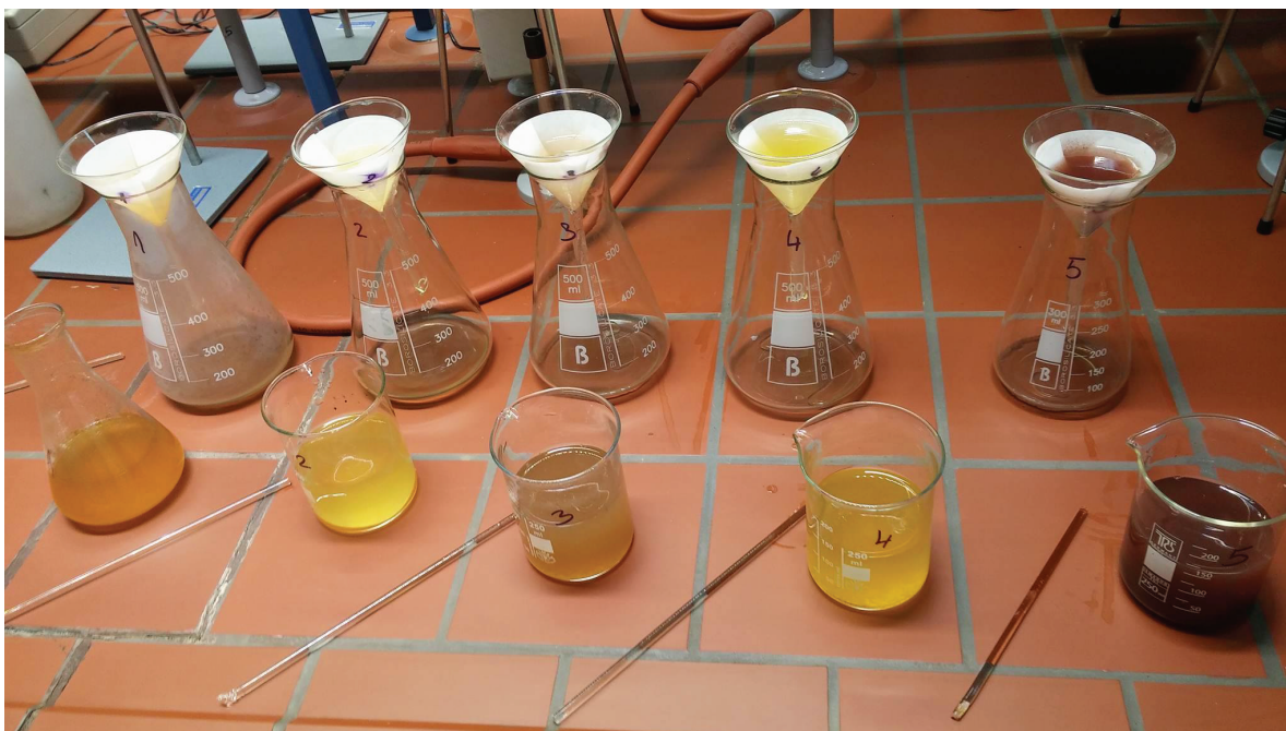
Slika 7. Filtriranje otopina preko filter papira (Izvor: autor)
