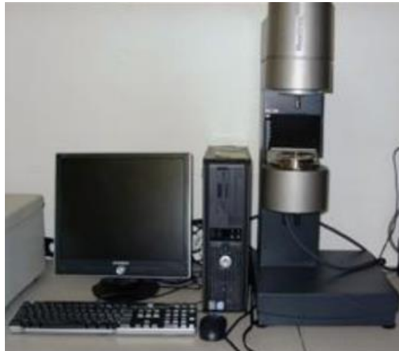
Slika 10. Reometar s koncentričnim cilindrima (Anonymous_8, 22.04.2017., url)
