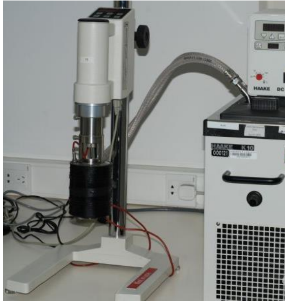
Slika 13. Rotacijski reometar s koncentričnim cilindrima VT550 362-0001 HAAKE (Anonymous_7, 22.04.2017., url)
