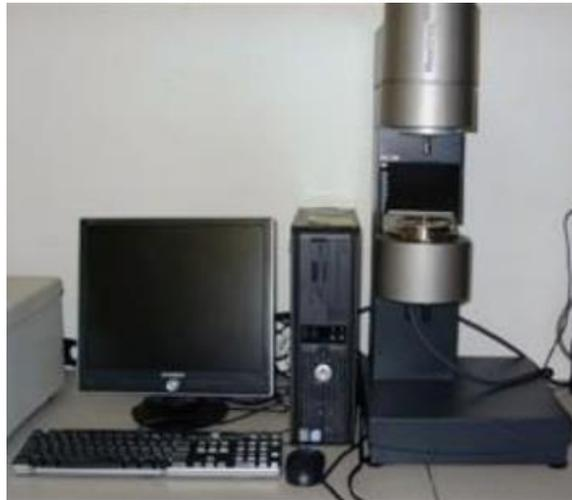
Slika 10. Reometar s koncentričnim cilindrima (Anonymous\_8, 22.04.2017., url)
