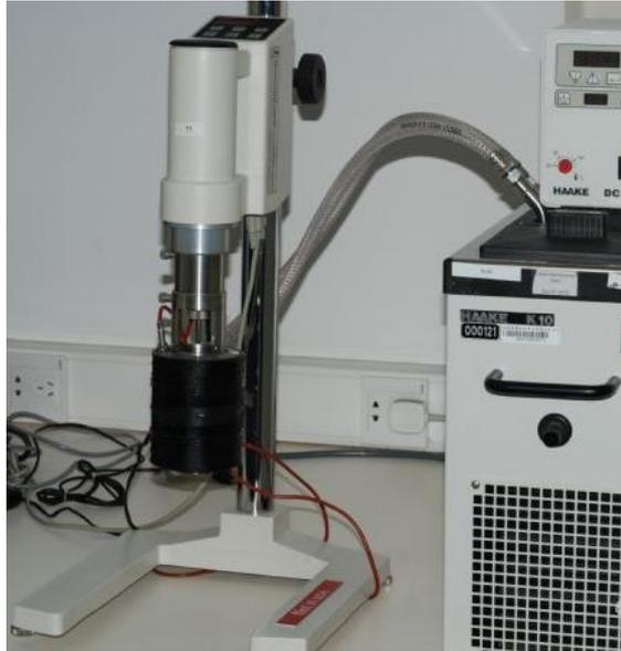
Slika 13. Rotacijski reometar s koncentričnim cilindrima VT550 362-0001 HAAKE
