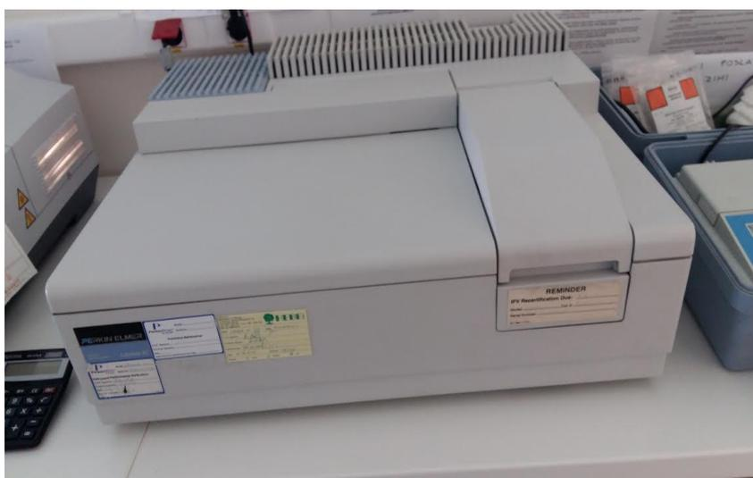
Slika 12. UV/VIS spektrofotometar Lambda 20, Perkin Elmer (Izvor: autor)
