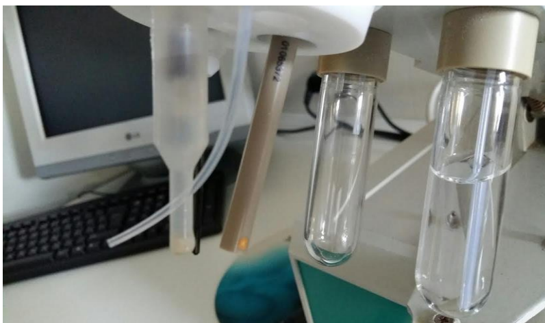
Slika 11. Zlatna rotirajuća elektroda na elektrokemijskom instrumentu Methrom 757 VA Computrace (Izvor: autor)
