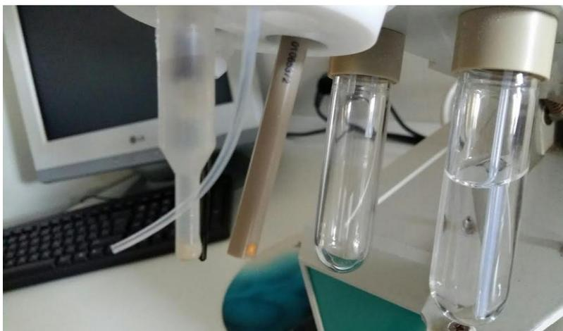
Slika 11. Zlatna rotirajuća elektroda na elektrokemijskom instrumentu Methrom 757 VA Computrace (Izvor: autor)
