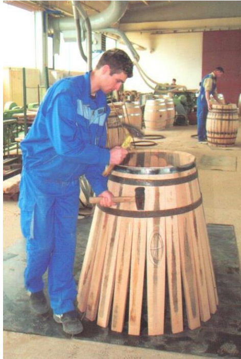
Slika 11. Slaganje plašta bačve (Izvor: AUREAmarketing, TOFRADO Barrique, 09.04.2017.)
