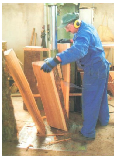
Slika 4. Cijepanje drveta za izradu dužica (Izvor: AUREAmarketing, TOFRADO Barrique, 07.04.2017.)
