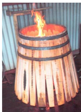
Slika 12. Paljenje bačve (Izvor: AUREAmarketing, TOFRADO Barrique, 09.04.2017.)
