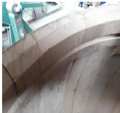
Slika 13. Utor za glavu bačve (Vlastiti izvor)
