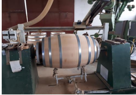
Slika 18. Završno brušenje bačve(Izvor: AUREAmarketing, TOFRADO Barrique, 09.04.2017.)
