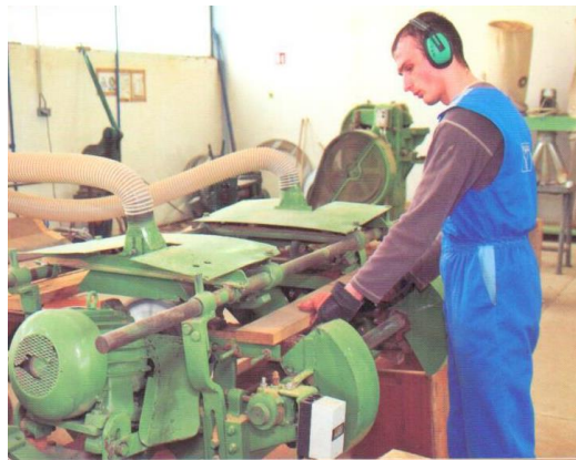
Slika 9. Izrada dužice dvolisnom kružnom pilom (Izvor: AUREAmarketing, TOFRADO Barrique, 09.04.2017.)
