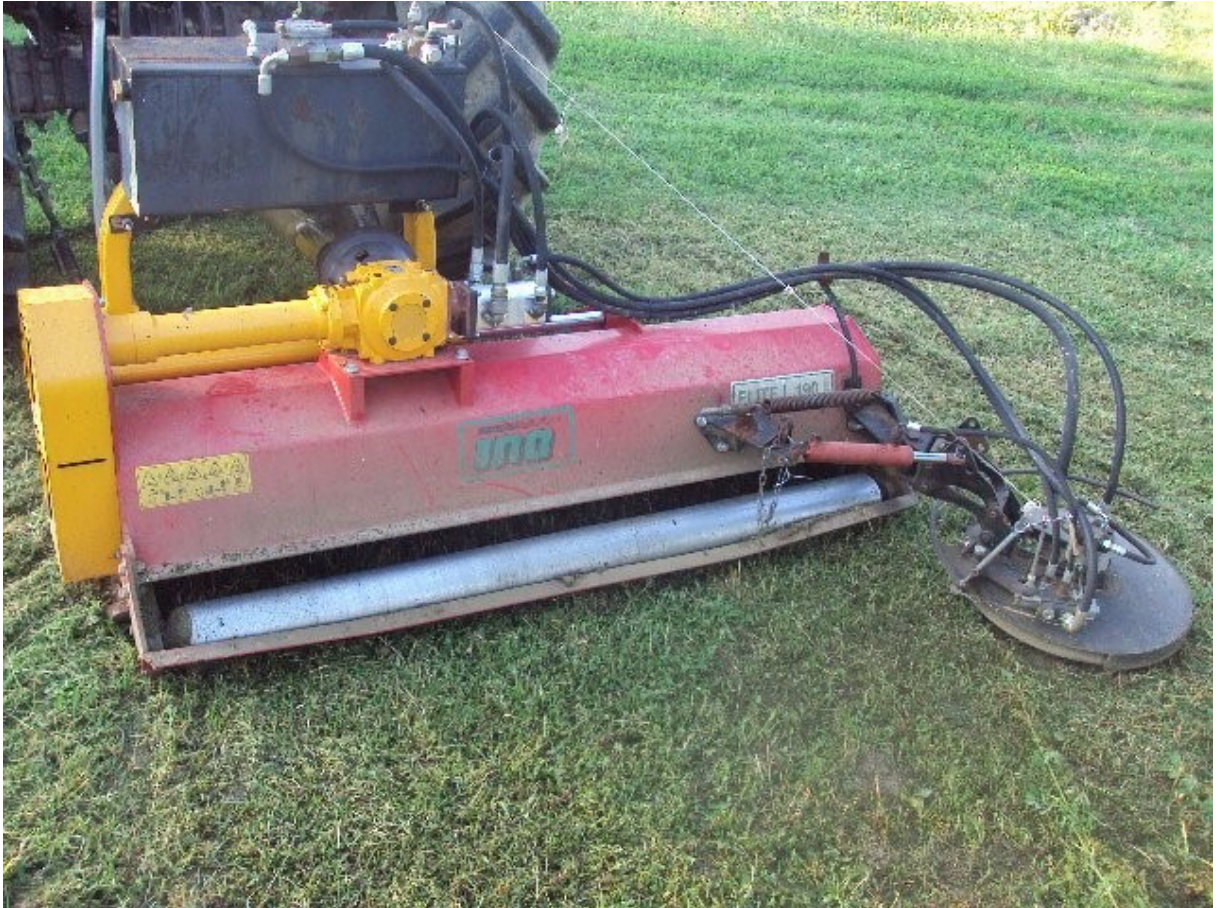
Slika 3.1. Malčer sa ticalom ( https://www.njuskalo.hr/dijelovi-obrada-tla/roto-malcer-ticalom-oglas-24148166 )
