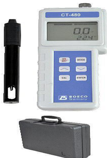
Slika 5. Prijenosni konduktometar(Anonymus_3, 16.6.2016.,url)
