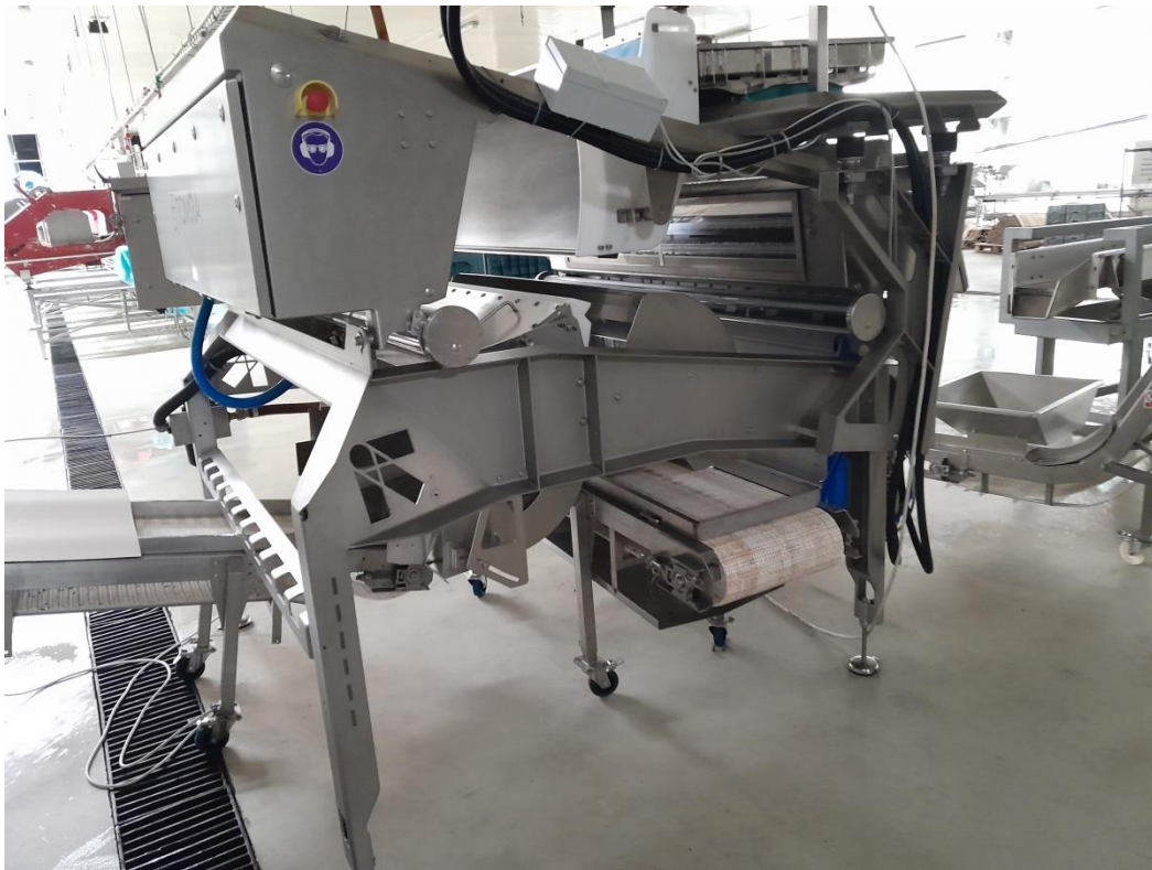
Slika 5. Optički sorter i 1. inspeksijska traka (Izvor: Autor)
