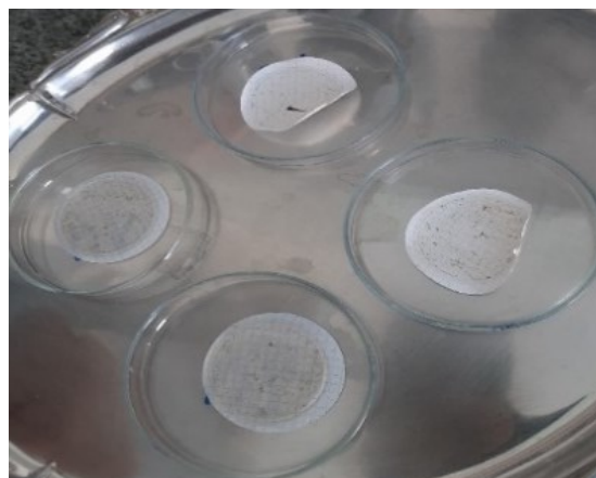
Slika 2. Izdvojena suspendirana tvar na filter papiru nakon mikrofiltracije (Izvor: autor)
