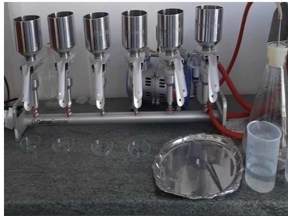
Slika 1. Mikrofiltracija uzorka otpadne vode (Izvor: autor)
