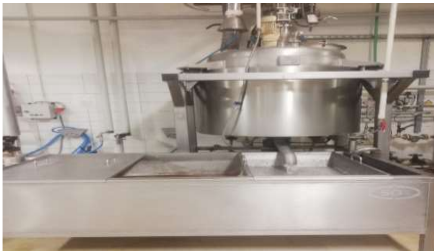
Slika 4. Duplikator (kotao) za ukuhavanje šećerno-sirupne otopine (izvor: autor)
