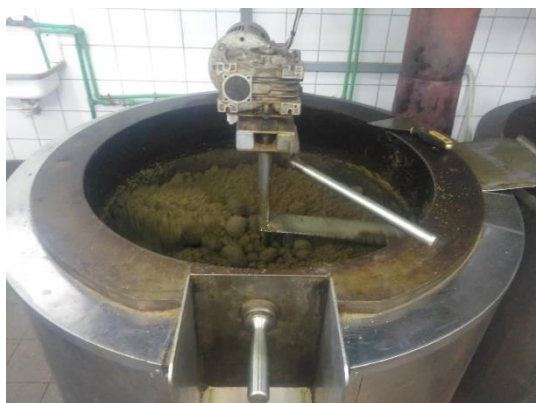
Slika 6. Početak prženja tijesta (Izvor: autor) Slika 7. Završetak prženja tijesta (Izvor: autor)
