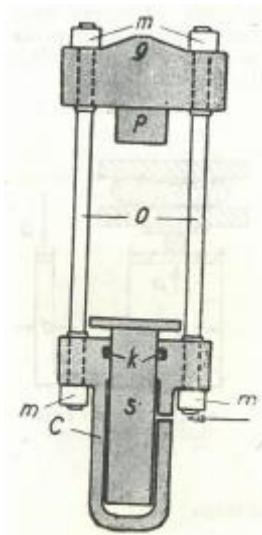
Slika 10. Shema hidraulične preše
