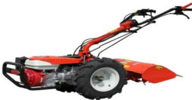
Slika 12. Jednoosovinski traktor (Izvor: www.goldoni.hr 21.6.2022)
