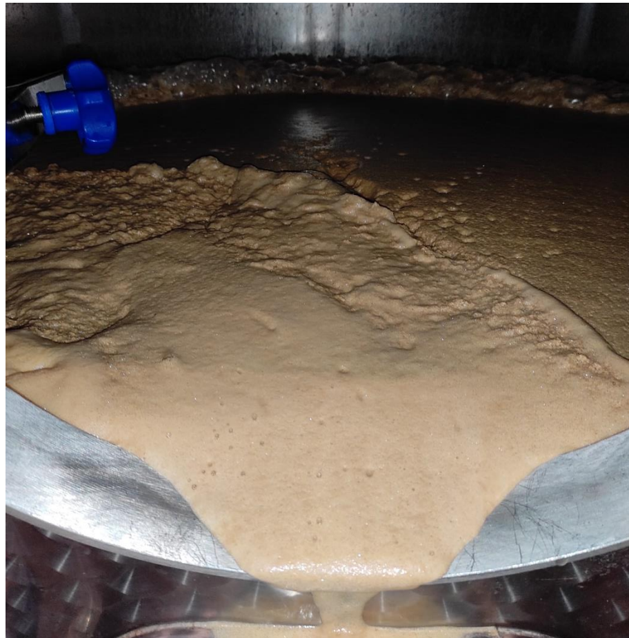
Slika 4. Pjena (talog) nakon flotacije (Izvor: autor)
