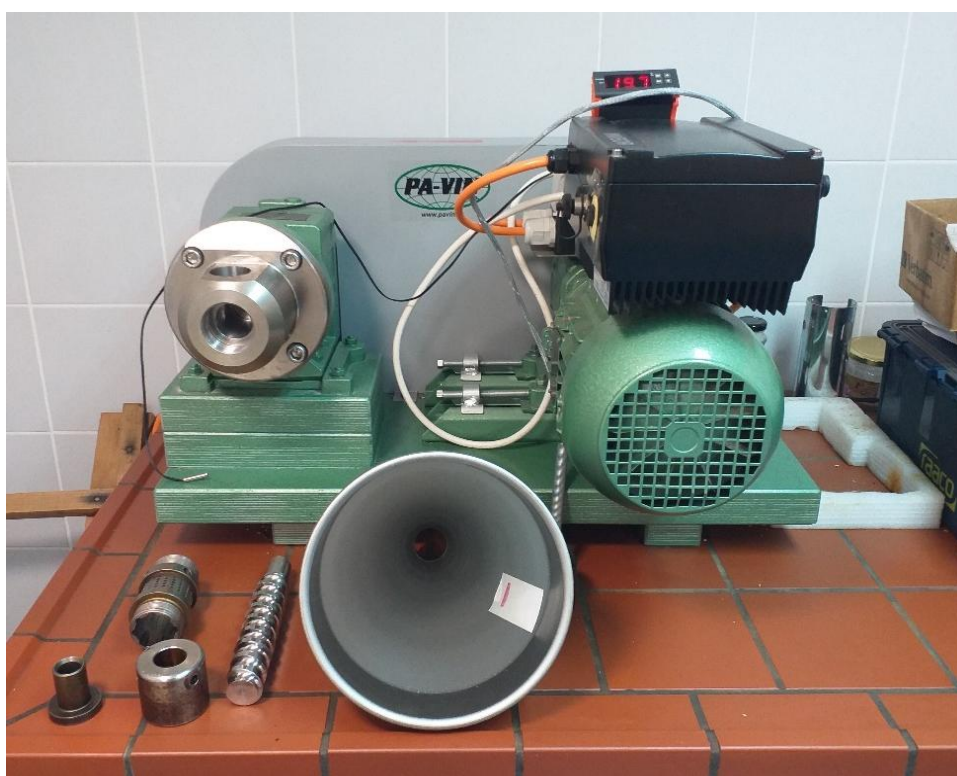
Slika 12. Vijčana preša KOMET CA 59 G (Izvor: autor, 2020.)
