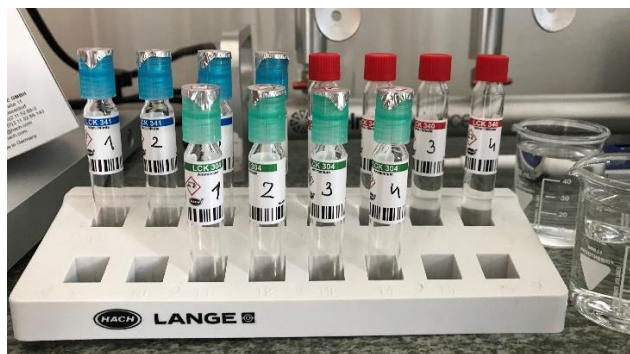
Slika 6. Kivetni testovi za određivanje nitrita, nitrata i amonijaka u vodi (Izvor: autor)
