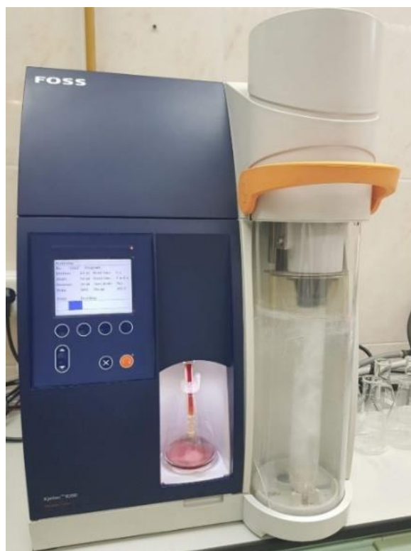
Slika 6. Postupak destilacije (Izvor: autor)
