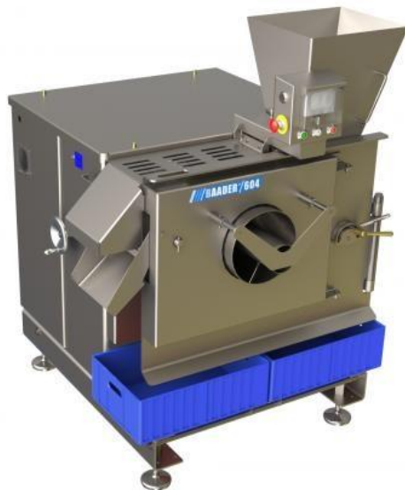
Slika 1. Stroj za miješanje i usitnjavanje mesa (Anacom, URL)
