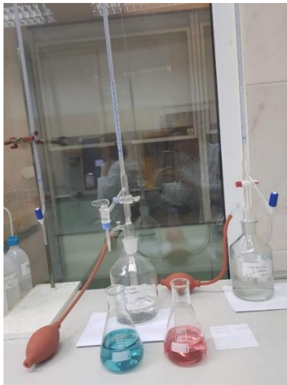
Slika 7. Postupak titracije (Izvor: autor)
