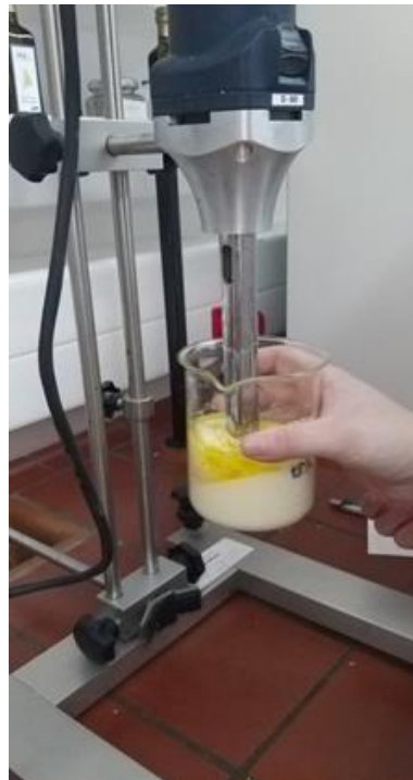
Slika 4. Proizvodnja majoneze pomoću homogenizatora (Izvor: autor)
