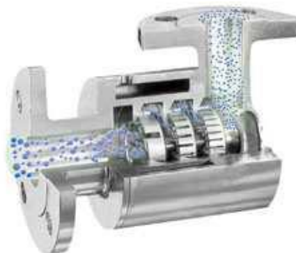
Slika 1. Unutrašnjost homogenizatora (Maxmixermachine, URL)
