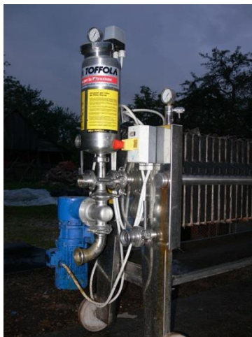
Slika 26. Klipna crpka u kombinaciji s filter-prešom (vlastiti izvor)
