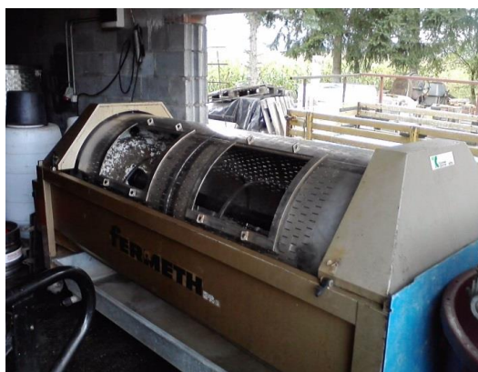
Slika 12. Horizontalni mehanički tijesak s navojnicom unutar koša (vlastiti izvor)
