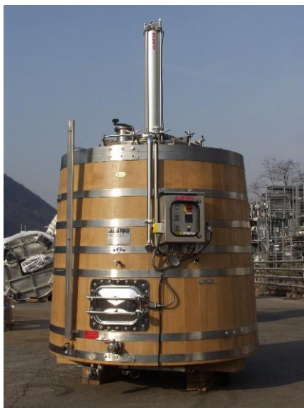
Slika 55. Vertikalni drveni vinifikator s pneumatskim zakretnim potiskivajućim sitom (izvor: www.freewtc.com )
