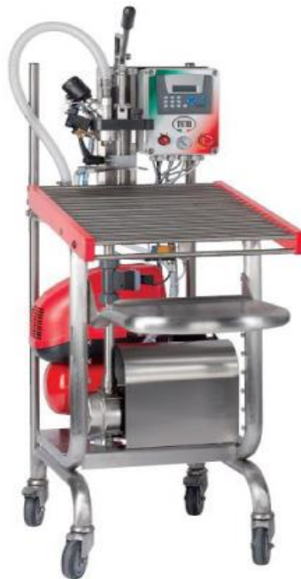
Slika 47. „Bag in box“ punionica (izvor: www.pavin.hr )
