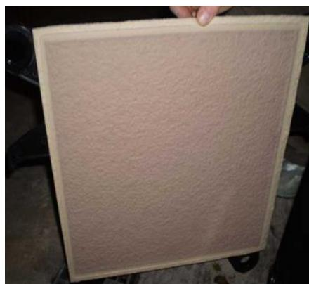
**Slika 33. Filter ploča nakon filtracije (vlastiti izvor)**
