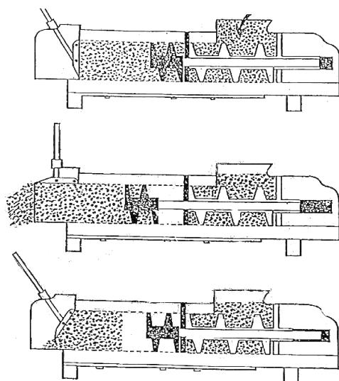
**Slika 22. Shematski prikaz rada kontinuiranog tjeska (izvor: Zoričić M. 1996.)**
