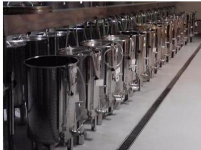
**Slika 51. Spremnići sa zračnim poklopcem (vlastiti izvor)**
