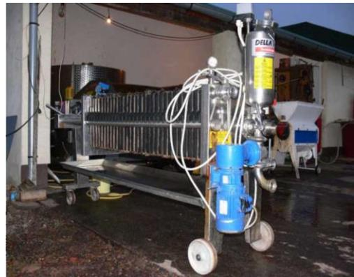
**Slika 36. Filter tjesak sa klipnom pumpom (vlastiti izvor)**
