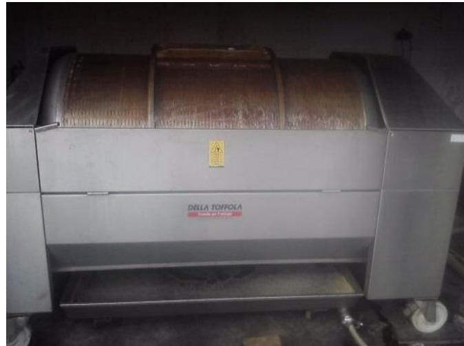
**Slika 19. Pneumatski tjesak - otvoreni tip (vlastiti izvor)**
