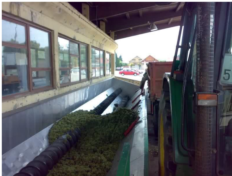
Slika 5. Primjer prijemnog bazena (izvor: www.poljoprivredni-forum.com )
