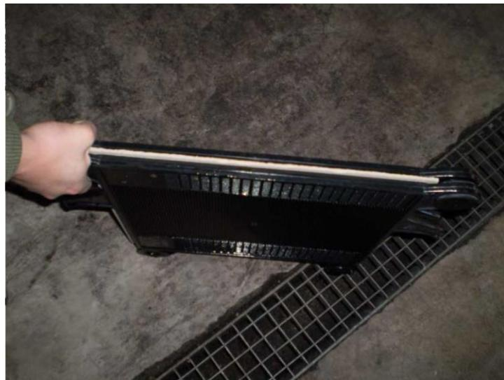
**Slika 32. Okvir s pločom pločastog filtra (vlastiti izvor)**
