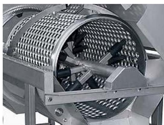
**Slika 7. cilindar za odvajanje peteljki s udaraljkama (izvor: [thevintnervault.com](http://thevintnervault.com))**
