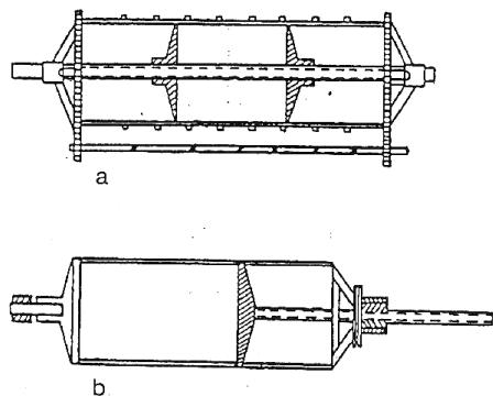
**Slika 13. Shematski prikaz mehaničke tjesaci a) s navojnicom unutar i b) s navojnicom izvan koša (izvor: Zoričić M. 1996.)**
