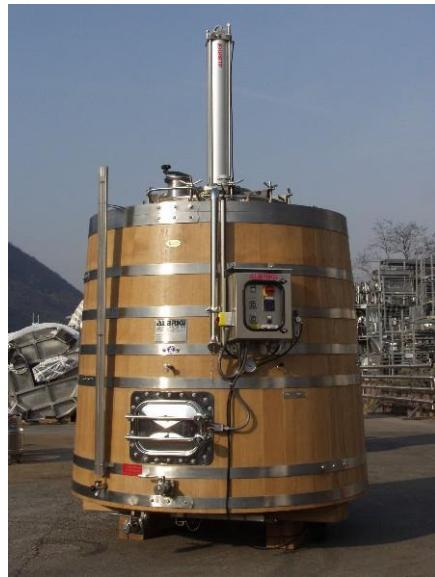
Slika 55. Vertikalni drveni vinifikator s pneumatskim zakretnim potiskivajućim sitom (izvor: [www.freewtc.com](http://www.freewtc.com))
