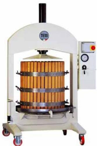
**Slika 18. Vertikalni hidraulični tjesak (izvor: [www.renaioli.net](http://www.renaioli.net))**
