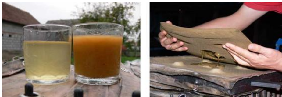
Slika 37. Talog poslije i prije filtracije (lijevo); Filtar kolač – talog nakon odstranjivanja sa filtra (vlastiti izvor)
