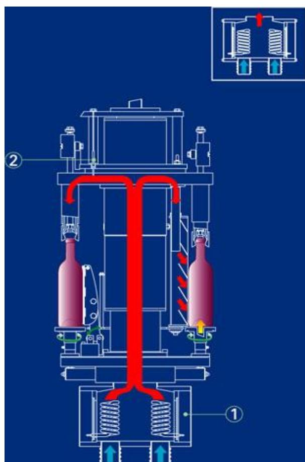
Slika 46. Anti kondenzacijski uređaj (izvor: [www.gai-it.com](http://www.gai-it.com))
