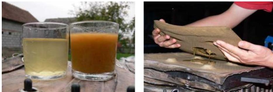
**Slika 37.Talog poslije i prije filtracije (lijevo); Filter kolač – talog nakon odstranjivanja sa filtra (vlastiti izvor)**
