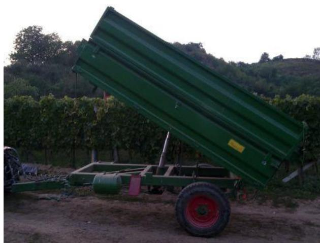
Slika 4. Hidraulički sustav za dizanje (vlastiti izvor)
