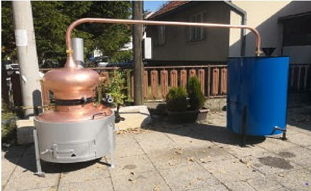
Slika 1. Aparatura za destilaciju rakije (Anonymous_1, url)
