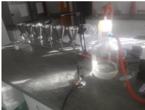
Slika 14. Uređaj za membransku filtraciju sa vakuum pumpom (Izvor: autor)
