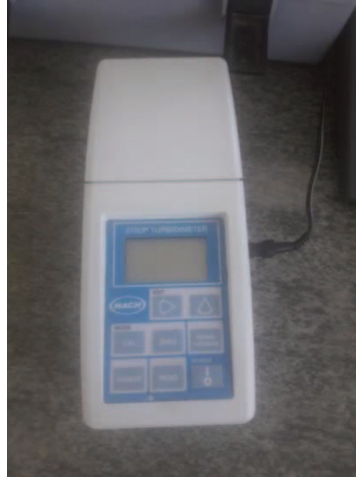
Slika 7. Turbidimetar (Izvor: autor)
