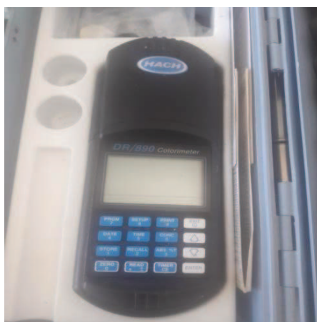
Slika 12. Kolorimetar (Izvor: autor)
