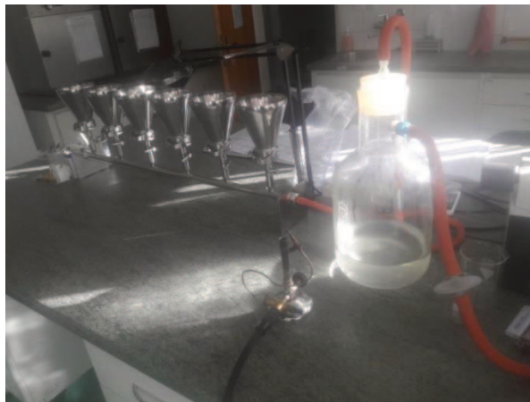
Slika 14. Uređaj za membransku filtraciju sa vakuum pumpom (Izvor: autor)
