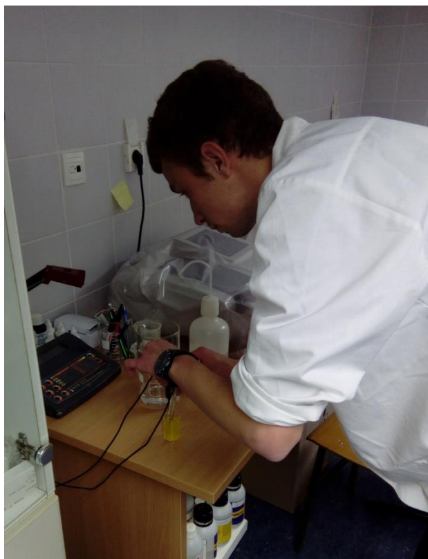
Slika 7. Određivanje realne kiselosti pH metrom ( Izvor: autor )
