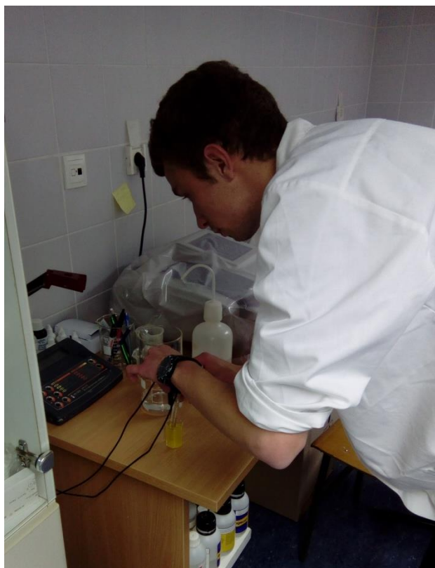
Slika 7. Određivanje realne kiselosti pH metrom ( Izvor: autor )
