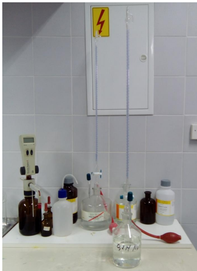
Slika 6. Titiranje uzorka otopinom NaOH (Izvor: autor)
