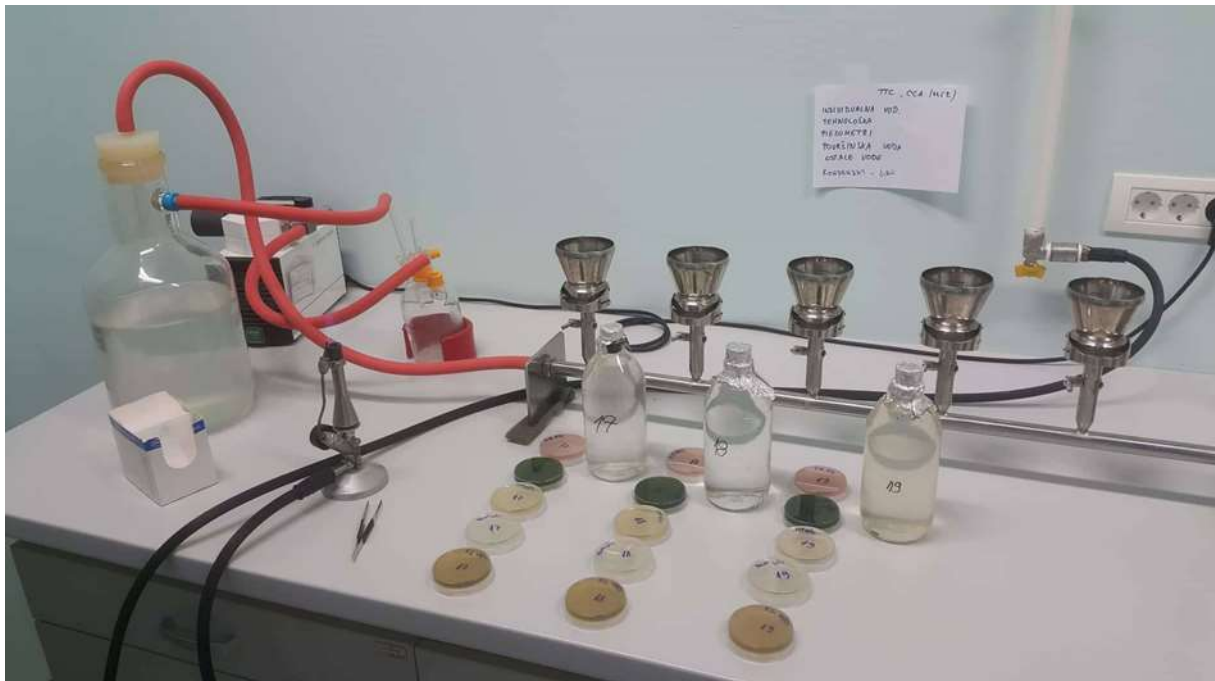
Slika 3. Uređaj za membransku filtraciju (Izvor: autor)
