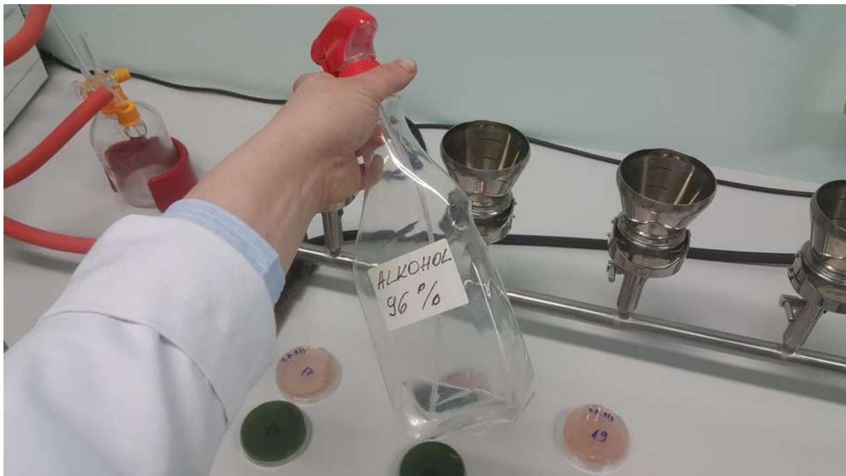
Slika 4. Sterilizacija pomoću 96 % alkohola (Izvor: autor)
