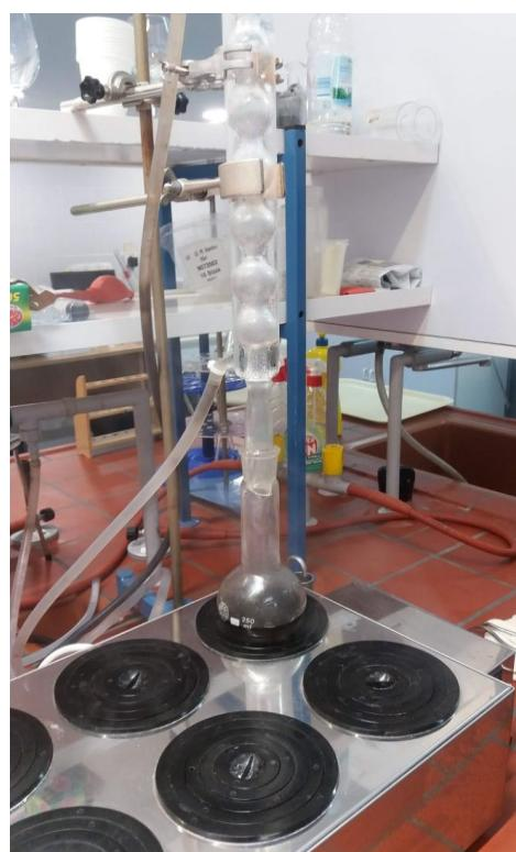
Slika 6. Kuhanje uzorka na vodenoj kupelji
