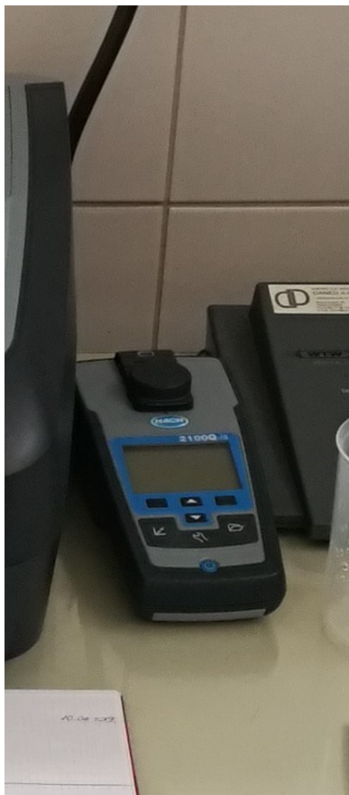
Slika 4. Turbidimetar (Izvor: autor)
