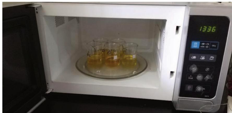
Slika 12. Uzorci ulja u mikrovalnoj pećnici, (Izvor: Autor)
