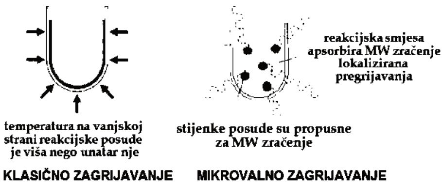
Slika 7. Shematski prikaz klasičnog i mikrovalnog zagrijavanja, ( FKIT, URL)
