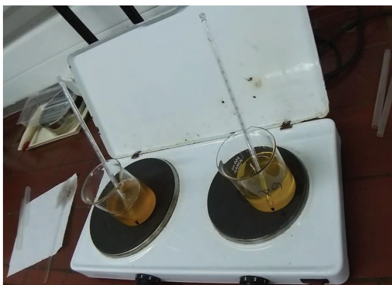
Slika 11. Zagrijavanje ulja uz dodatak antioksidansa, (Izvor: Autor)
