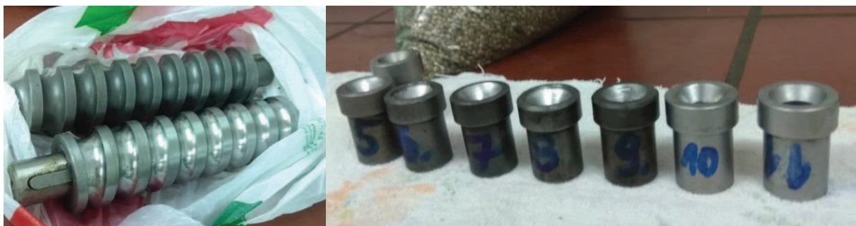
Slika 9. Pužnice pužne preše i nastavci različitog promjera za izlaz pogače (izvor: autor)
