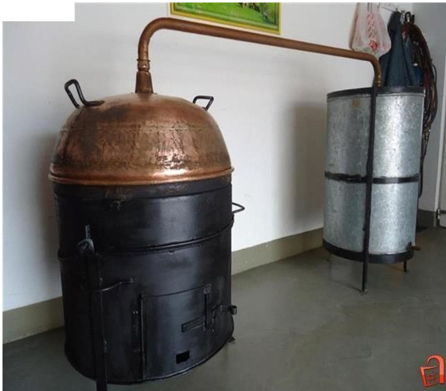
Slika 1. Jednostavan uređaj za destilaciju (Anonymous_1, URL)
