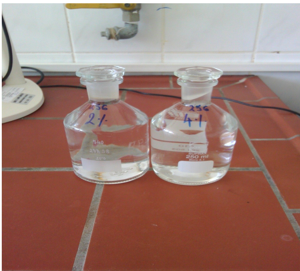
Slika 6. Winkler boce za određivanje BPK 5
