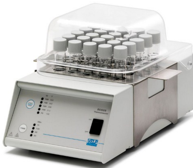
Slika 7. COD reaktor za određivanje KPK (Anonymus_12, 13.6.2016. url)
