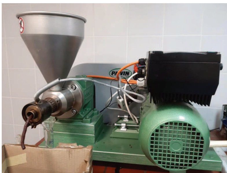
Slika 17. Izgled vijčane preše (Vlastiti izvor)
