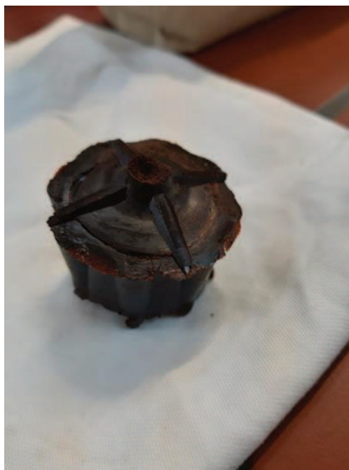
Slika 20. Čep stvoren u mlaznici preše zbog presušenih sjemenki (Vlastiti izvor)
