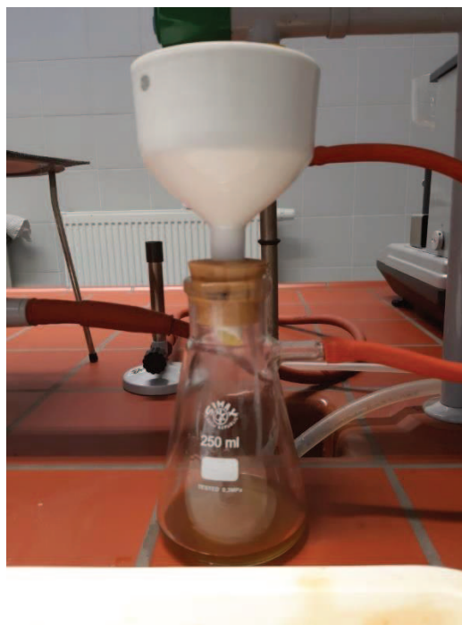
Slika 22. Prikaz rada vakuum filtera (Vlastiti izvor)
