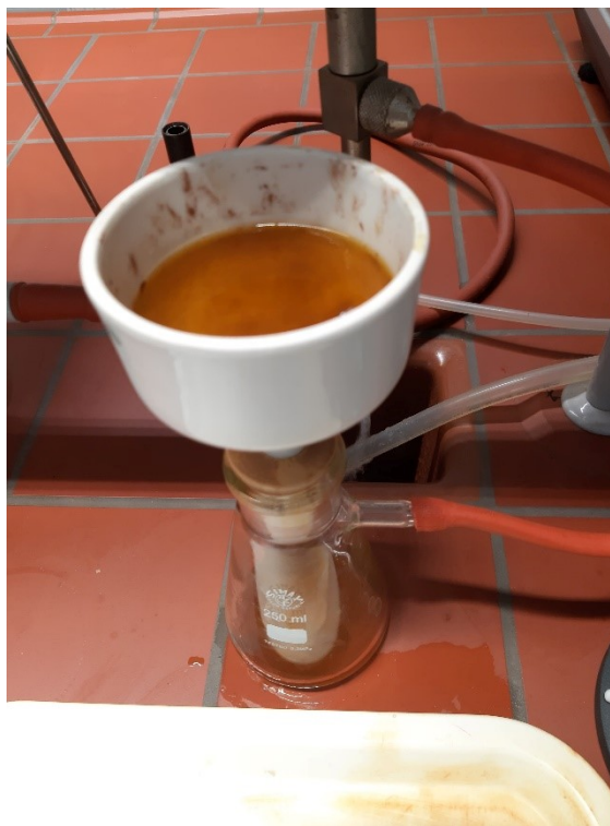
Slika 18 Filtracije kroz vakuum filter (Vlastiti izvor)
