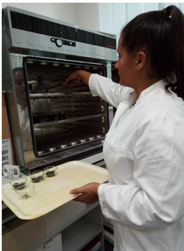
Slika 15 Stavljanje uzoraka u sušionik (Vlastiti izvor)
