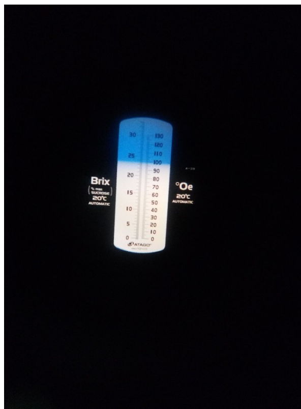
Slika 9 Skala u refraktometru (Vlastiti izvor)
