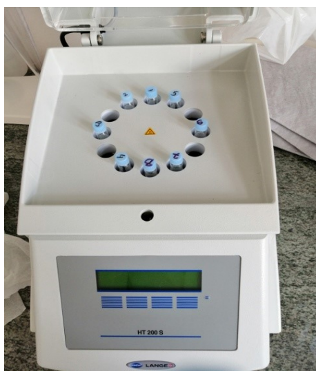
Slika 5. Termoreaktor sa kivetama prije zagrijavanja (autor)
