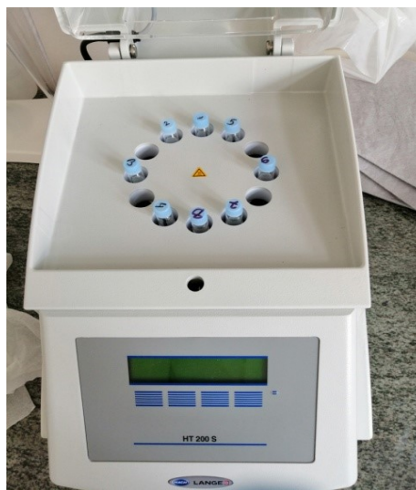
Slika 5. Termoreaktor sa kivetama prije zagrijavanja (autor)
