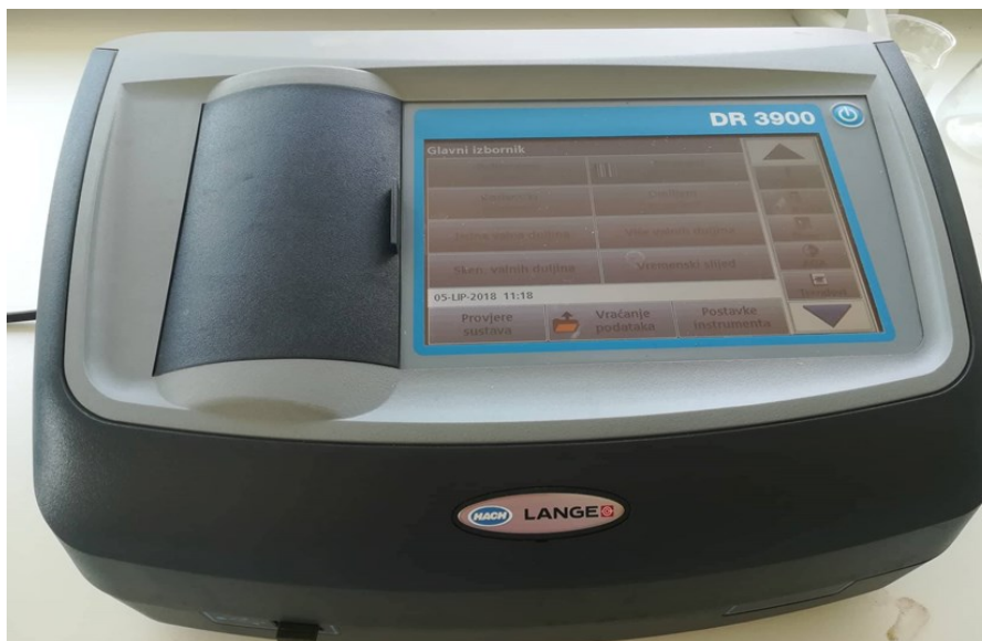
Slika 13. Spektrofotometar (Izvor: autor)
