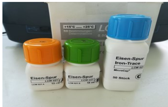
Slika 14. Gotovi testovi za mjerenje koncentracije željeza LCW O21 (Izvor: autor)
