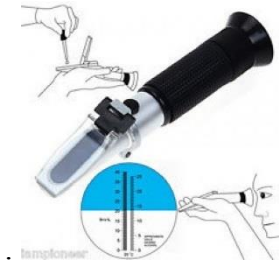
Slika 5. Refraktometar (izvor: anonymus)
